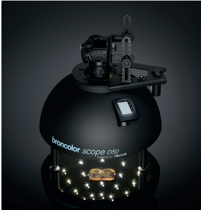
Abb. 2. Ein am DHLab entwickelter Lichtdom zur Aufnahme von RTI Aufnahmen.
